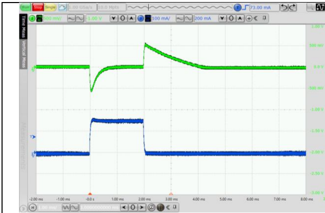
图 7.5 负载瞬态响应 (1 mA to 150mA, V_{IN}=7V , V_{OUT}=5V )
