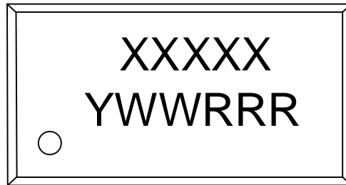
图 C.1 SOT23-5 顶部印记
