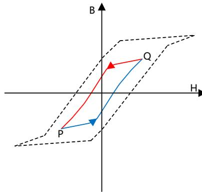
图 7.3 全桥变压器磁芯磁化曲线
