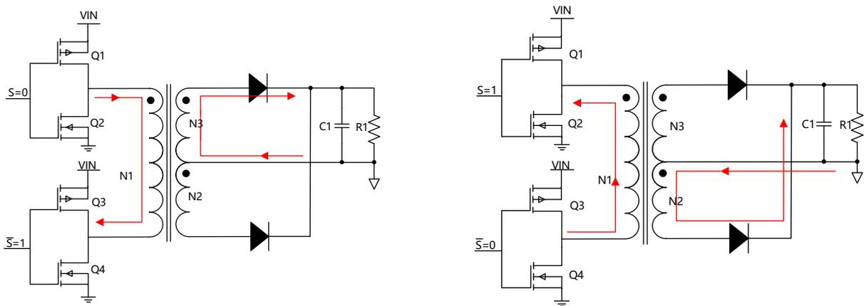
图 7.2 全桥变换器的工作过程示意图
