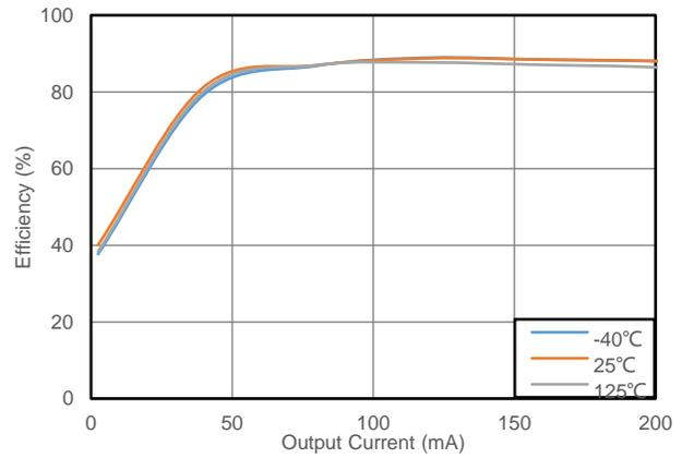
图 7.4 转换效率 vs 输出电流
