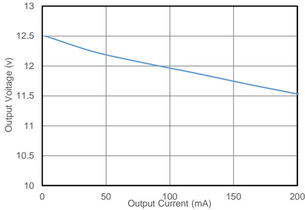
图 7.1 输出电压 vs 输出电流
