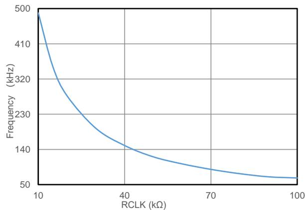
图 7.4 工作频率 vs CLK 电阻
