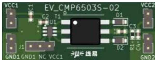
图 3.2 PCB 示意图(尺寸: 16 x 42mm)
