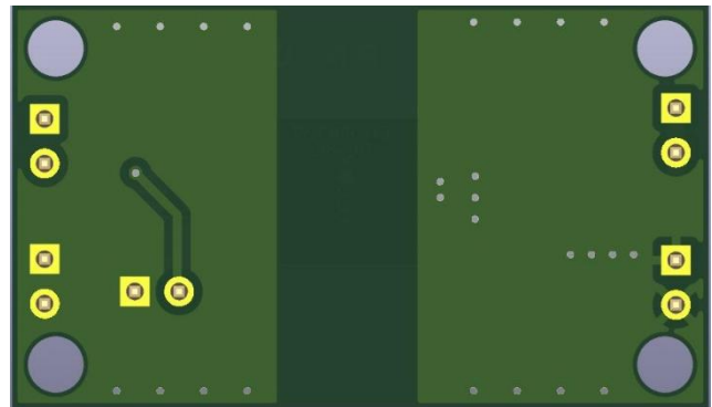
图 3.4 PCB 版图反面 (尺寸: 23 x 40mm)
