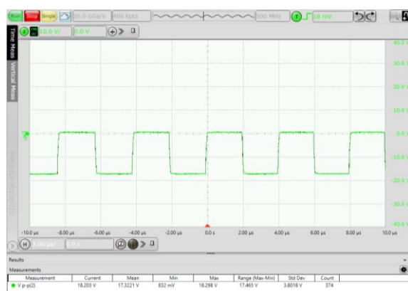
图 6.4 满载二极管工作电压波形
