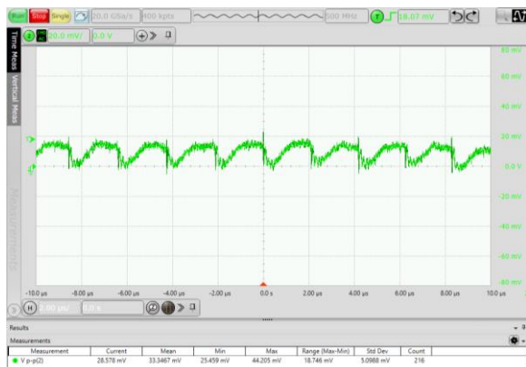
图 6.1 半载输出电压纹波波形
