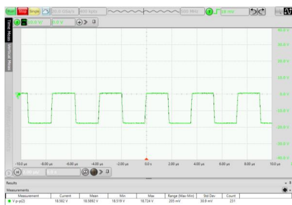
图 6.3 半载二极管工作电压波形
