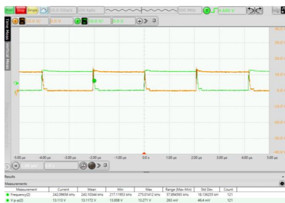
图 6.6 满载 VDS 波形
