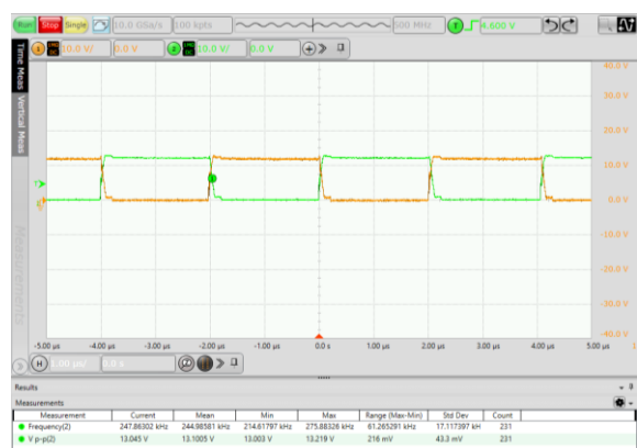
图 6.5 半载 VDS 波形
