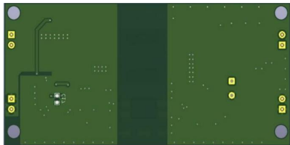
图 3.3 PCB 版图反面 (尺寸: 35x 75mm)
