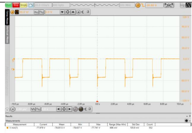
图 6.6 副边输出二极管应力波形 (VIN=36V, 满载)
