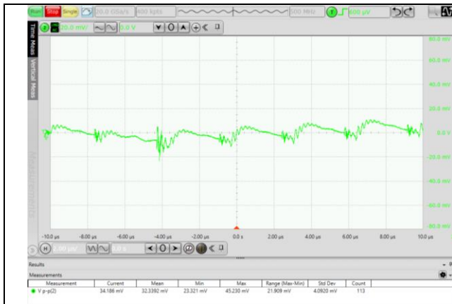
图 6.1 输出电压纹波波形 (VIN=24V, 5%负载)
