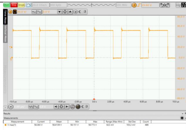
图 6.5 MOS 管电压应力波形 (VIN=36V, 满载)
