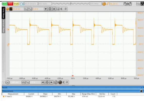
图 6.5 MOS 管电压应力波形 (VIN=36V, 满载)
