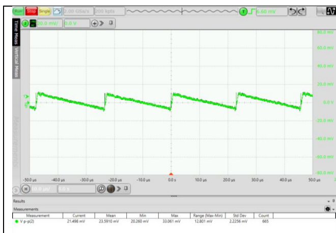
图 6.1 输出电压纹波波形 (VIN=24V, 5%负载)
