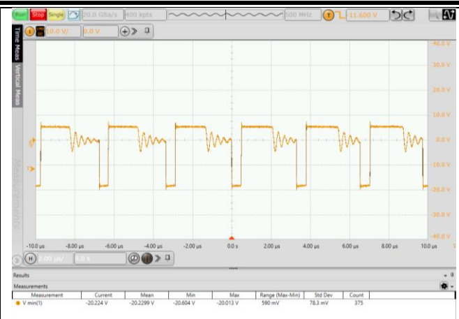
图 6.6 副边输出二极管应力波形 (VIN=36V, 满载)
