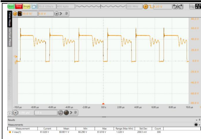
图 6.5 MOS 管电压应力波形 (VIN=36V, 满载)
