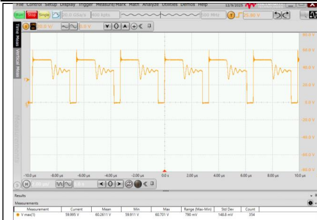
图 6.5 MOS 管电压应力波形 (VIN=36V, 满载)
