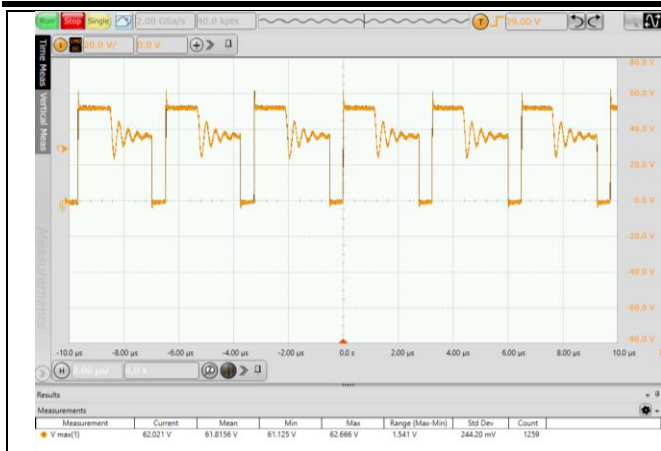
图 6.5 MOS 管电压应力波形 (VIN=36V, 满载)
