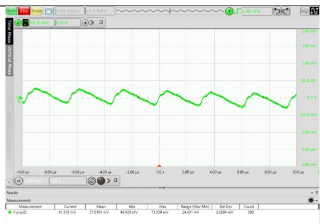
图 6.2 输出电压纹波波形 (VIN=24V, 100%负载)
