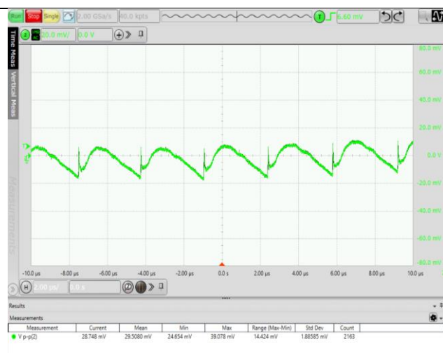
图 6.2 输出电压纹波波形 (VIN=12V, 100%负载)
