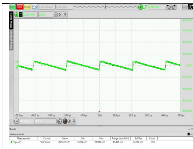
图 6.1 输出电压纹波波形 (VIN=12V, 5%负载)
