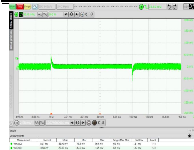
图 6.3 25% -50% -25%IO 动态波形 (VIN=12V)
