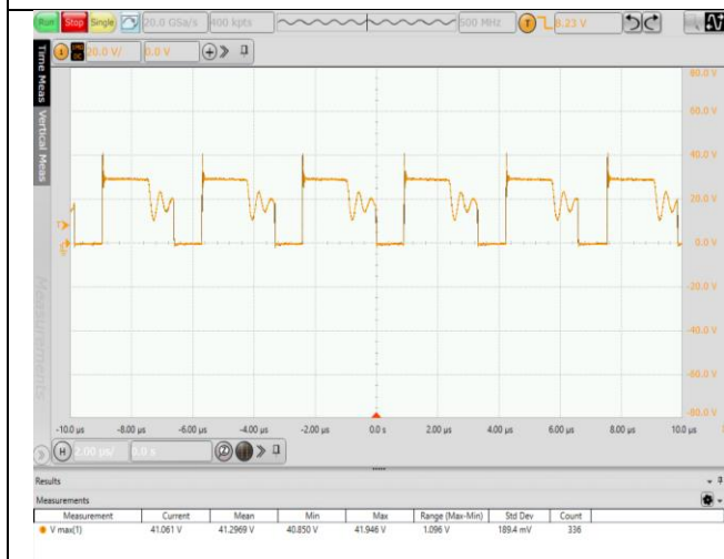
图 6.3 25% -50% -25%IO 动态波形 (VIN=12V)
