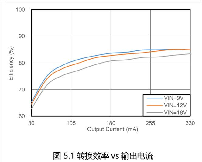
图 5.1 转换效率 vs 输出电流
