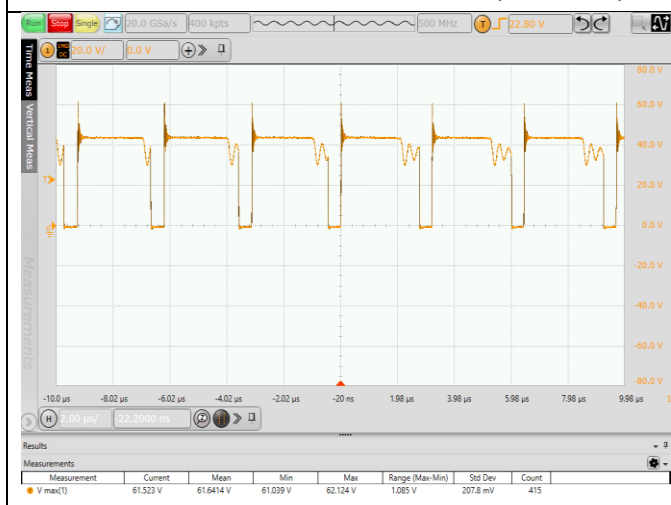
图 6.3 25% -50% -25%IO 动态波形 (VIN=24V)
