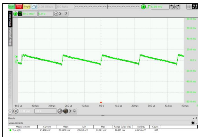
图 6.1 输出电压纹波波形 (VIN=24V, 5%负载)
