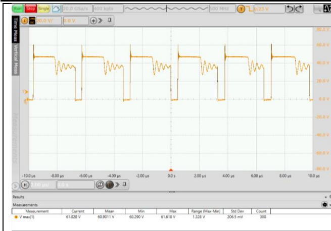
图 6.5 MOS 管电压应力波形 (VIN=36V, 满载)
