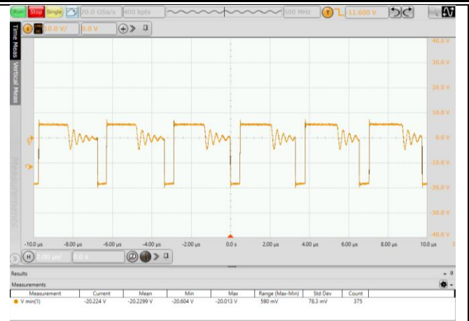
图 6.6 副边输出二极管应力波形 (VIN=36V, 满载)
