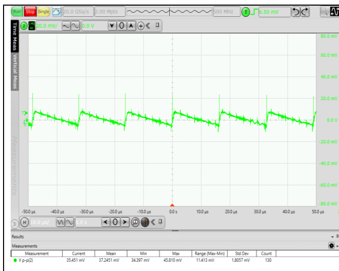
图 6.1 输出电压纹波波形 (VIN=24V, 5%负载)
