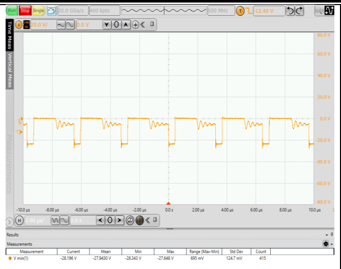
图 6.6 输出整流二极管电压波形 (VIN=36V, 满载)
