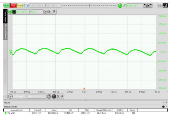
图 6.2 输出电压纹波波形 (VIN=24V, 100%负载)
