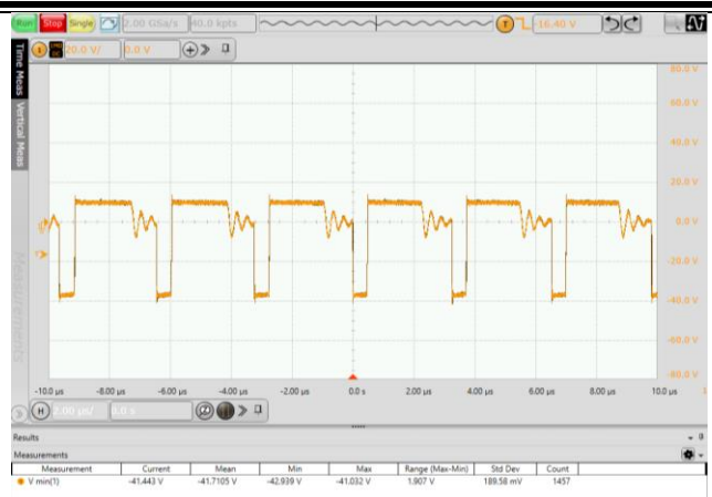
图 6.6 副边输出二极管应力波形 (VIN=36V, 满载)
