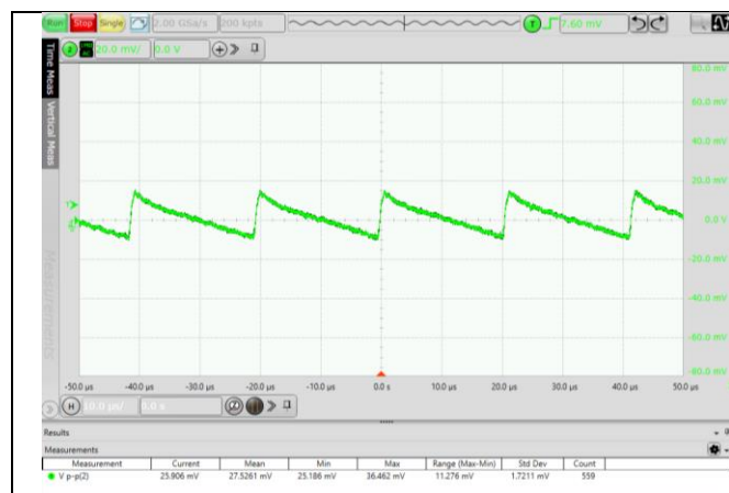
图 6.1 输出电压纹波波形 (VIN=24V, 5%负载)
