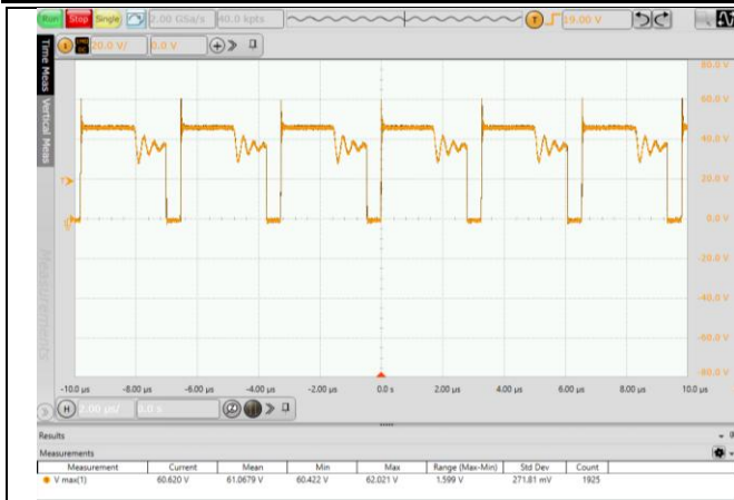
图 6.5 MOS 管电压应力波形 (VIN=36V, 满载)
