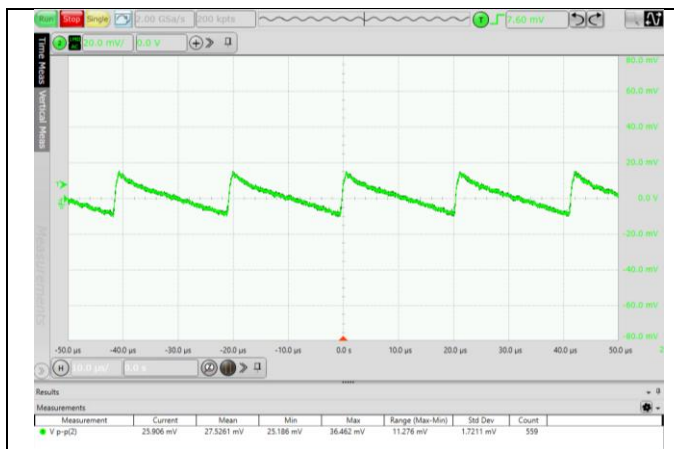
图 6.1 输出电压纹波波形 (VIN=24V, 5%负载)
