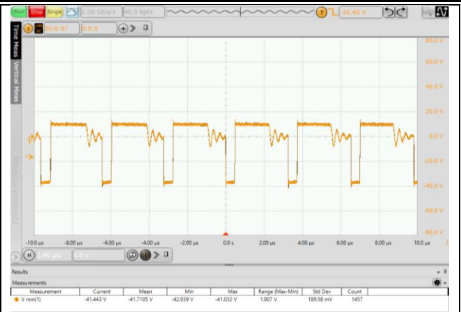
图 6.6 副边输出二极管应力波形 (VIN=36V, 满载)
