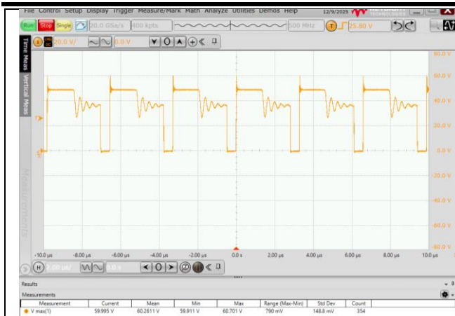
图 6.5 MOS 管电压应力波形 (VIN=36V, 满载)
