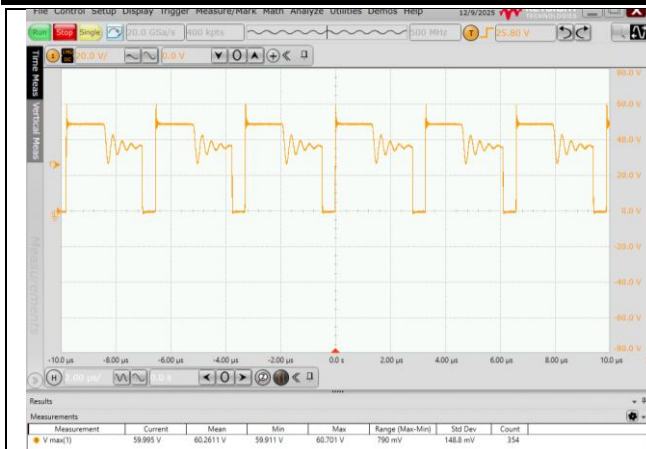
图 6.5 MOS 管电压应力波形 (VIN=36V, 满载)
