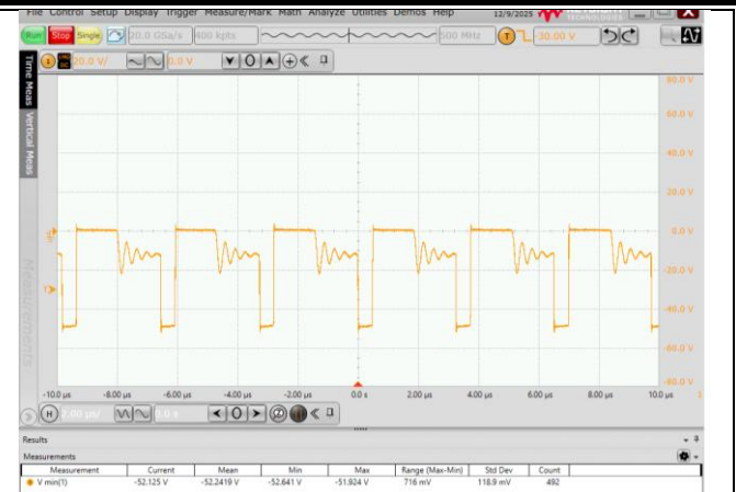
图 6.6 副边输出二极管应力波形 (VIN=36V, 满载)
