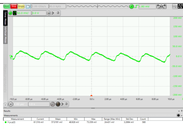
图 6.2 输出电压纹波波形 (VIN=24V, 100%负载)
