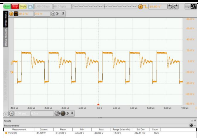
图 6.6 副边输出二极管应力波形 (VIN=36V, 满载)
