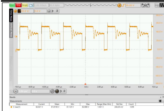
图 6.5 MOS 管电压应力波形 (VIN=36V, 满载)
