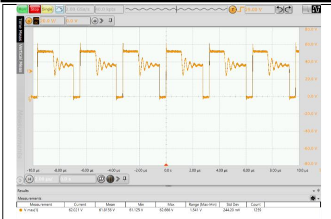
图 6.5 MOS 管电压应力波形 (VIN=36V, 满载)
