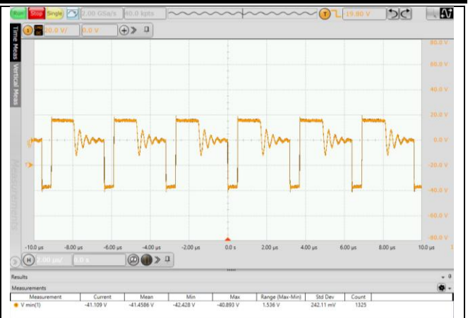
图 6.6 副边输出二极管应力波形 (VIN=36V, 满载)
