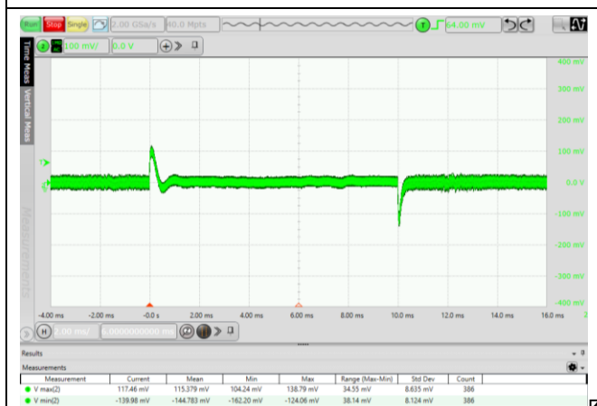
图 6.1 输出电压纹波波形 (VIN=24V, 5%负载)
