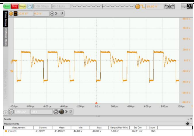
图 6.6 副边输出二极管应力波形 (VIN=36V, 满载)
