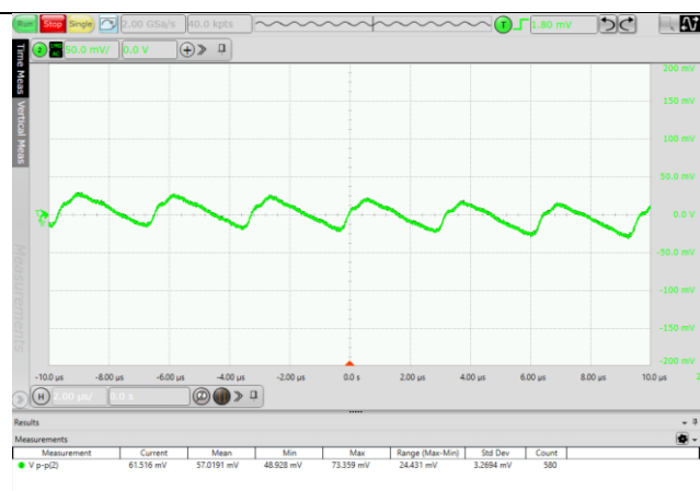
图 6.2 输出电压纹波波形 (VIN=24V, 100%负载)
