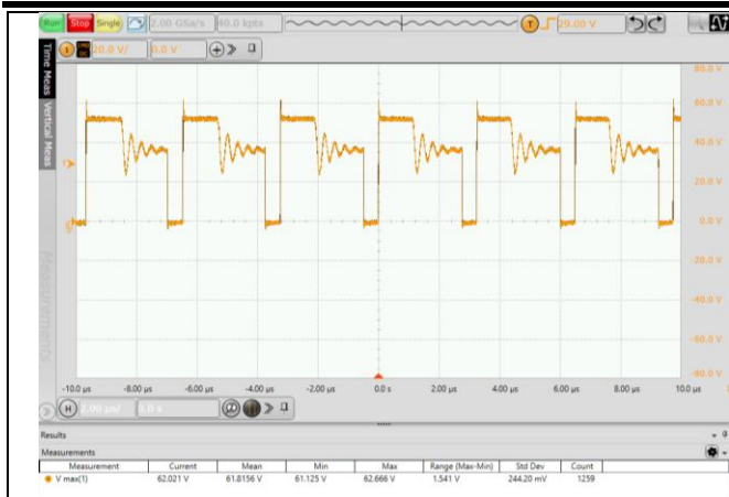
图 6.5 MOS 管电压应力波形 (VIN=36V, 满载)
