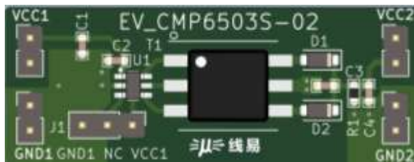
图 3.2 PCB 示意图(尺寸: 16 x 42mm)
